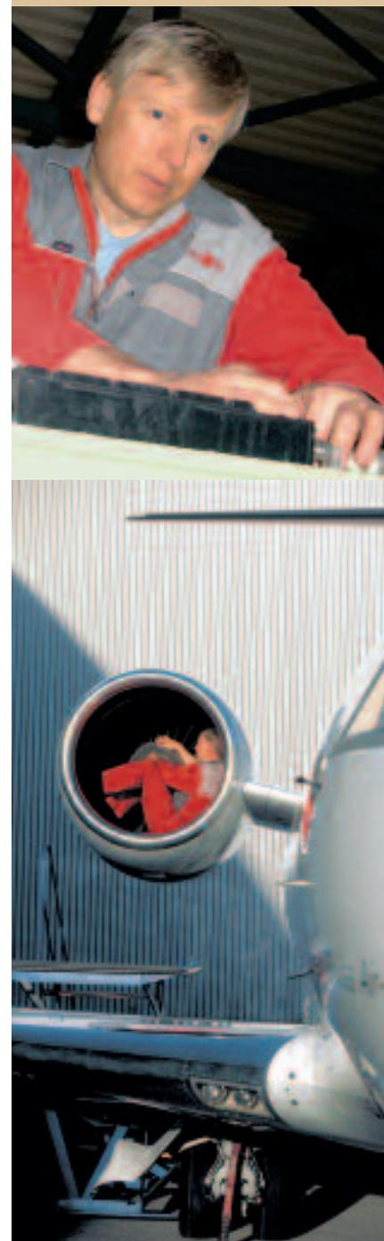
Albert Hertaeg, einer von sieben Rega-Flugzeugtechnikern, sucht die einzelnen Triebwerkschaufeln nach Spuren von Beschädigungen ab.
